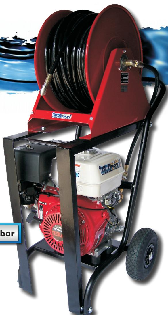
Die **Schubkraft** der **Rückstrahldüsen** treibt den flexiblen Hochdruckschlauch **ohne Kraftaufwand** durch die Rohrleitung. Je nach Düsenausstattung werden optimale Ergebnisse zur perfekten radialen Reinigung erzielt.
